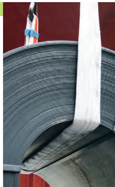
Alle Coilschlingen sind standardmäßig mit zwei Ösen von 0,3 m Länge ausgerüstet.
